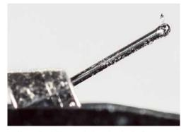
In dieser Preisklasse sind weder der im P-1 verbaute Bor-Nadelträger noch der Multifacettenschliff seines Abtastdiamanten üblich.
